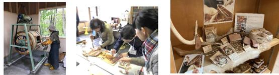
木製ドラムでシカ皮を洗浄する様子、なめした革を製品に加工
